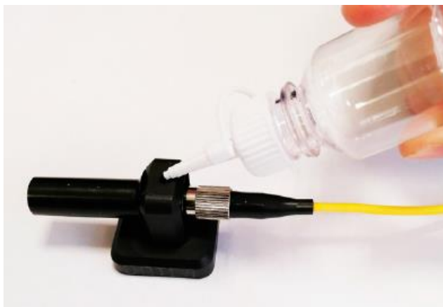
Рис.5. Долив иммерсионной жидкости в АГВ.
