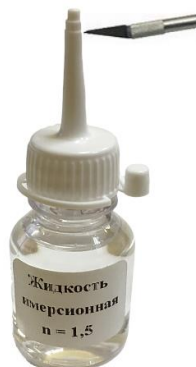
Рис.4. Срезать вершину «носика» бутылочки с иммерсионной жидкостью.
