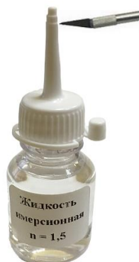
Рис.4. Срезать вершину «носика» бутылочки с иммерсионной жидкостью.
