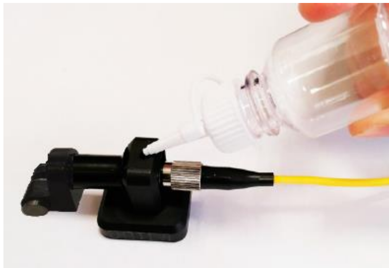
Рис.5. Долив иммерсионной жидкости в АГВ.
